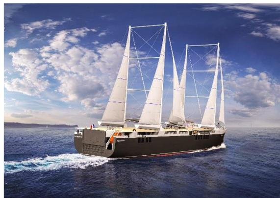
En associant à la propulsion éolienne principale une vitesse régulée et une gestion optimisée du mix énergétique, la solution de NEOLINE permettra de **réduire jusqu'à 90% la consommation d'énergie**, et donc les émissions polluantes associées, comparées à celles d'un cargo traditionnel sur le même trajet.
